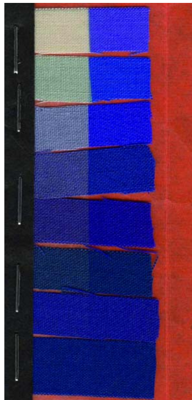
Figuur 7. ISO Blauwe wol standaard: acht stalen wol blootgesteld aan 120 Mlx.h (UV-rijk). Het kleurverschil tussen de belichte linker- en onbelichte rechterkant loopt van ISO 1 \Delta E = 45 (boven, 30 jwv: totaal verbleekt) via ISO 4 \Delta E = 15 (10 jwv) tot ISO 8 \Delta E = 1,5 (onder, 1 jwv).
